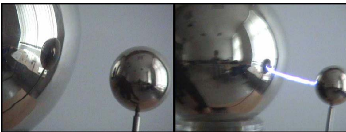
Obrázek 36: Nalevo – za suchého vzduchu je k výboji zapotřebí alespoň 30 \text{ kV na cm} ; napravo – elektrostatický výboj.
