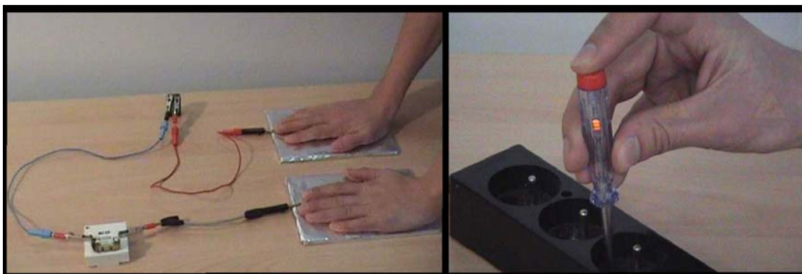
Obrázek 25: Nalevo – ani v obvodu s baterií 9 V neteče dostatečný proud pro rozsvícení žárovky; napravo – elektrikářská zkoušečka svítí, tedy tělo vede proud.
