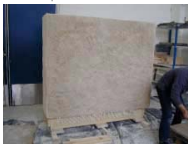
Figure 21 Mur paille avec enduits
