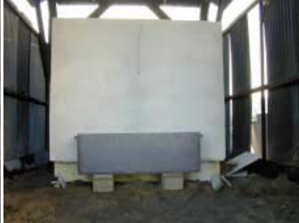
Figure 36 - Mise en place du réservoir d'heptane
