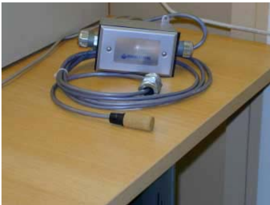
Figure 49 – Sonde et convertisseur GENERAL EASTERN RH T2-IR
