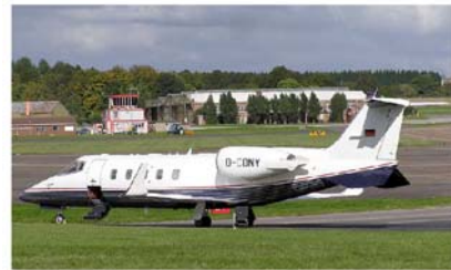
Obrázok C.10 Bombardier Learjet 60XR prepravujúci osem pasažierov pri rýchlosti 780 km/h spotrebuje 150 kWh na 100 osobo-km. Fotografia: Adrian Pingstone.
