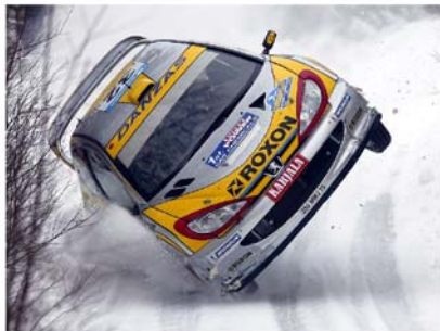
Obrázok A.1 Peugeot 206 má koeficient odporu 0,33. Fotografia: Christopher Batt.
