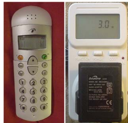
Obrázok 11.3 Tento neefektívny bezdrôtový telefón a jeho nabíjačka odoberá 3 W, keď sa nechá v zástrčke. To je 0,07 kWh/d. Ak je cena elektriny 10 pencí za kWh, potom 3 W znamenajú 3 libry za rok.
