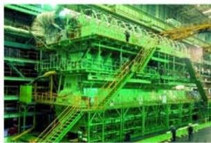
Obrázok A.15 Wartsila-Sulzer RTA96-C 14-cylindrový dvojtaktný naftový motor. 27 metrov dlhý a 13,5 metra vysoký. http://www.wartsila.com/ .
