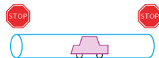
Obrázok A.4 Aby sme zistili, či sa výkon spotrebuje hlavne v brzdnom systéme alebo na prekonanie odporu vzduchu, porovnáme hmotnosť vozidla s hmotnosťou vzduchovej trubice medzi dvomi značkami STOP.
