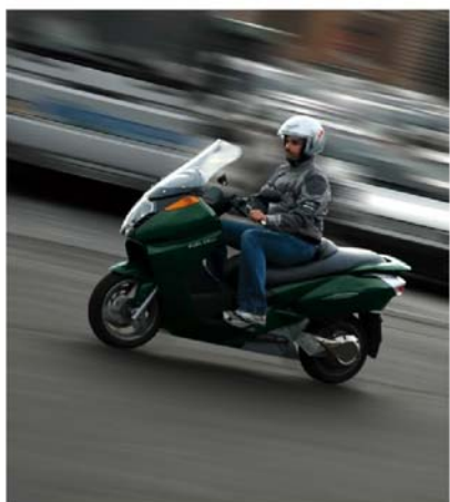
Obrázok 20.44 Vectrix: 2,75 kWh na 100 km. Fotografia: www.vectrix.com .
