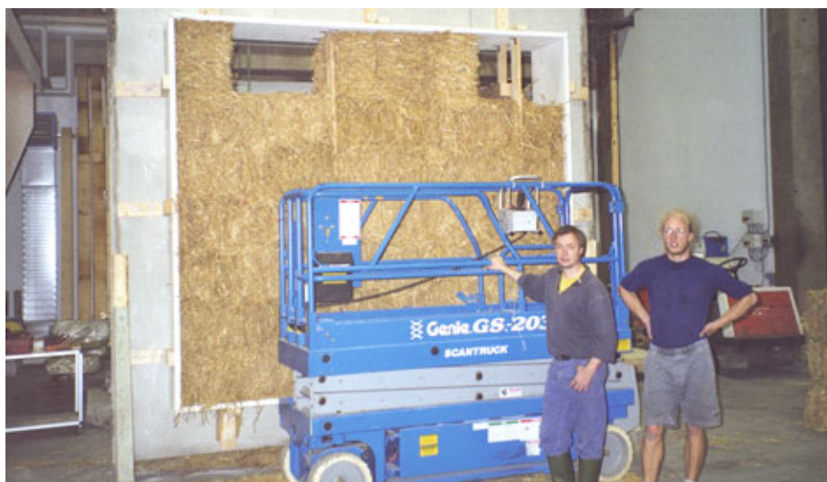
Figur 48. Opbygning af halmvæg beregnet til test af brandbeskyttelsesevne.
