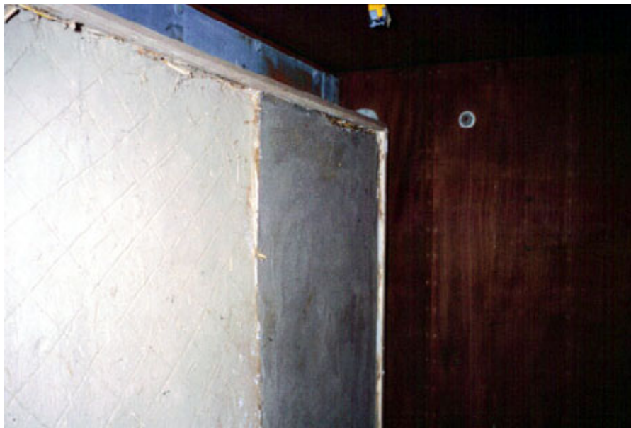
Figur 43. Varm-kold kasse på By og Byg. Her testes fugtphobningen i halmvægge med to forskellige pudstyper (ler- og kalkpuds).
