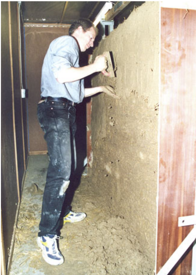
Figur 38. Med pudsebræt pudses testemner 2. gang med ler tilsat snittet halm.
