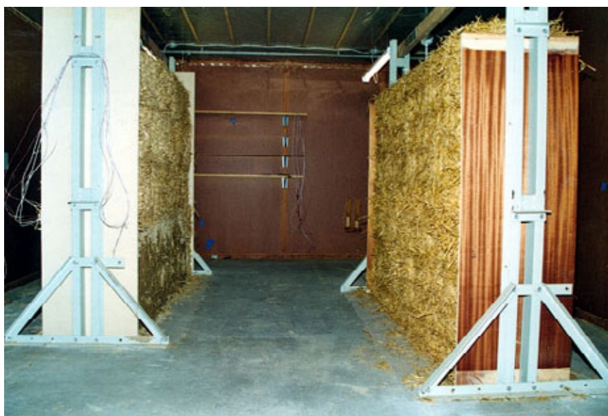
Figur 46. Halmvæg til sætningsmåling (før pudsnings) i traditionelle baller tv. og i bigballer th.
