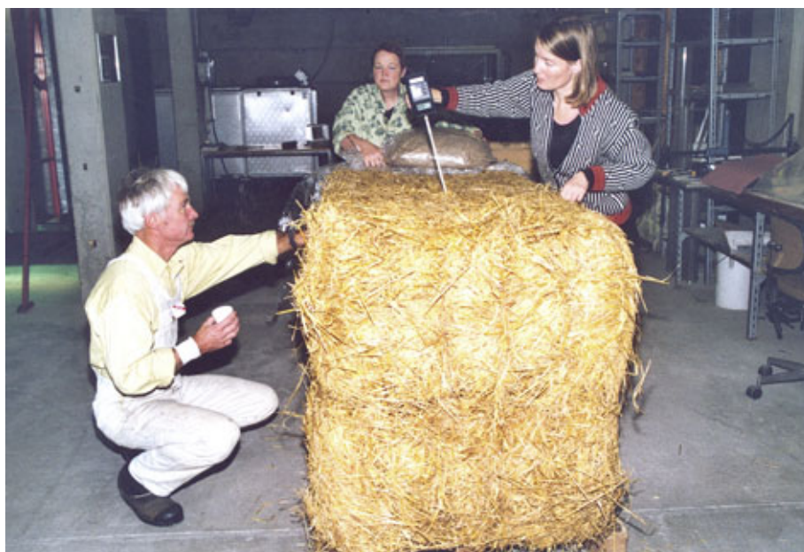
Figur 56. Bigballer vejes og testes for fugtindhold inden brug. (Foto: Jan Carl Westphal).
