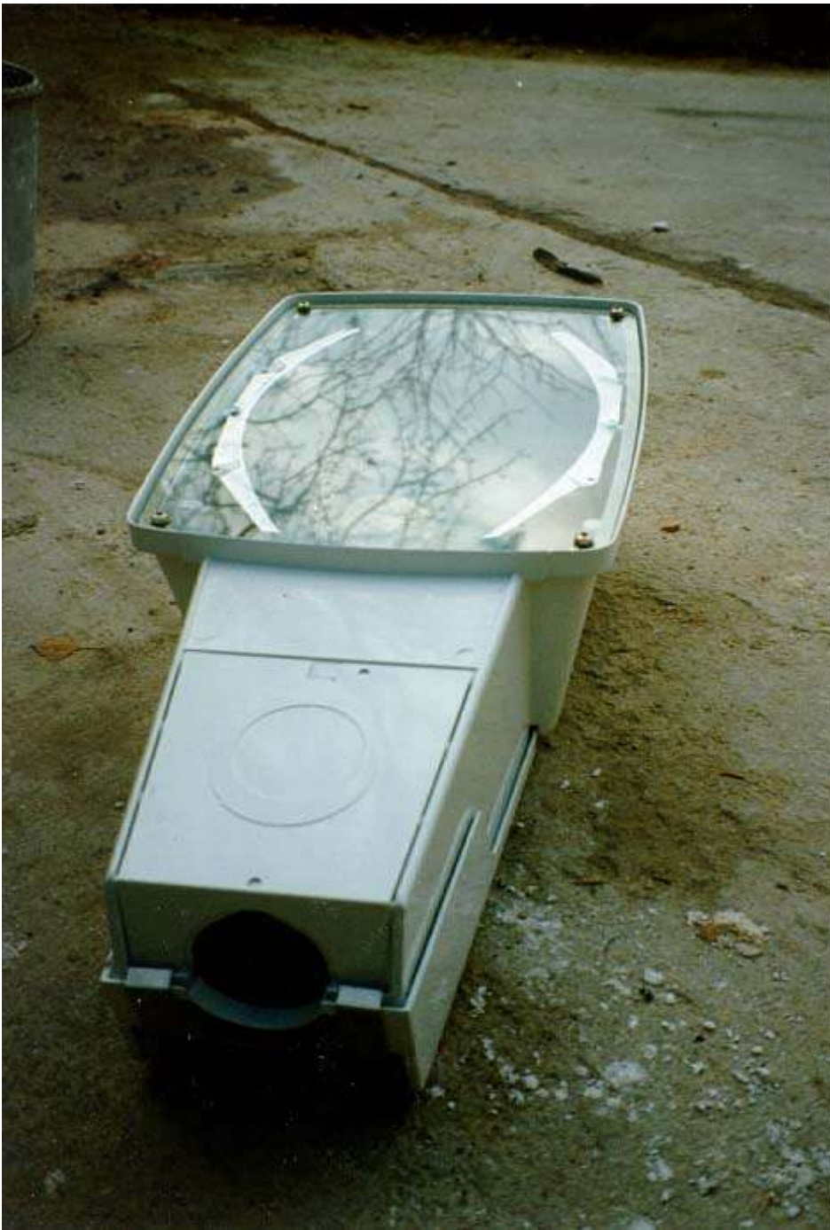
Detail svítidla užívaného ve Svitavách. Za kaleným rovinným sklem jsou důmyslná zrcadla.
