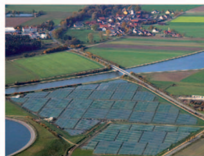
Obrázok 6.7 Solárna fotovoltická elektrárňa: 6,3 MW (maximum) Solarpark v Muhlhausene, v Bavorsku. Predpokladaný priemerný výkon je 5 W/m 2 . Fotografia: SunPower.
