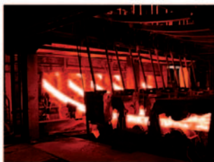
Obrázok H.1 Nепretržité liatie oceľových ingotov v kórejskej Iron and Steel Company.
