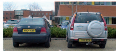
Obrázok A.5 Výkon spotrebovaný na pohon vozidla je priamo úmerný prierezu jeho čelnej plochy počas jeho jazdy mimo mesta a jeho hmotnosti počas jazdy v meste. Uhádnite, ktoré auto je úspornejšie: VW na ľavej strane alebo terénne auto na pravej strane?
