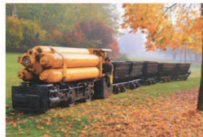
Obrázok 20.24 Hore: Električka na stlačený vzduch v Nantes čerpajúca vzduch a paru. Na poháňanie týchto vozidiel sa spotrebovalo 4,4 kg uhlia (36 kWh) na kilometer, alebo 115 kWh na 100 o-km , ak by boli vozidlá plné. [5qhvcb] Dole: lokomotíva na stlačený vzduch; hmotnosť 9,2 t, tlak 175 barov, výkon 26 kW. Fotografie s láskavým povolením: Rüdiger Fach, Rolf-Dieter Reichert a Frankfurter Feldbahnmuseum.
