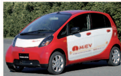
Obrázok 20.38 i MiEV od spoločnosti Mitsubishi Motors má 47 kW motor, hmotnosť 1 080 kg, maximálnu rýchlosť 130 km/h.
