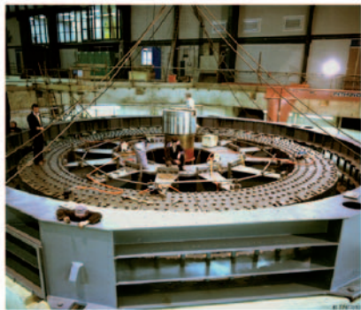
Obrázok 26.15 Jeden z dvoch zotrvačníkov vo výskumnom centre v Culhame, v štádiu konštrukcie. Fotografia: EFDA-JET. www.jet.edfa.org .
