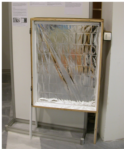
Obrázek 8: Model okna s elektricky navíjenou foliovou roletou
