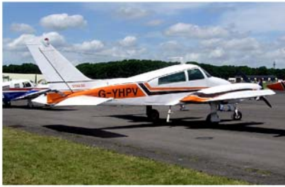
Obrázok C.9 Cessna 310N: 60 kWh na 100 osobo-km. Cessna 310 Turbo odvezie 6 pasažierov (vrátane pilota) rýchlosťou 360 km/h. Fotografia: Adrian Pingstone.
