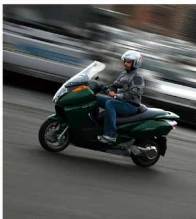
Obrázok 20.44 Vectrix: 2,75 kWh na 100 km. Fotografia: www.vectrix.com .
