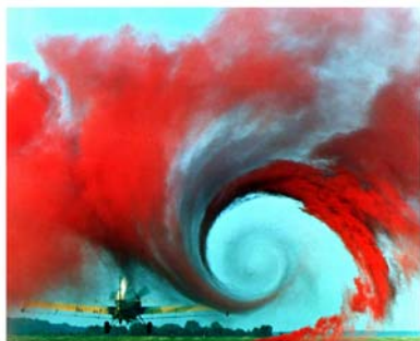
Obrázok C.4 Vzduch prúdiaci za lietadlom. Fotografia: NASA Langley Research Center.
