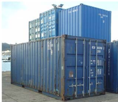
Obrázok I.4 20-stopový kontajner (1 TEU).
