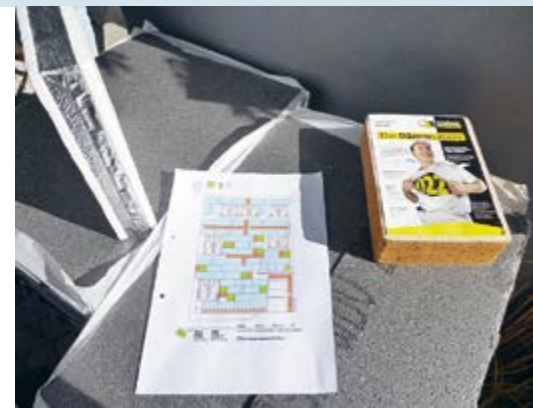
Ernst-May-Häuser, Donnersbergstraße, Frankfurt am Main, Wärmedämmung mit Vakuumisulationspaneele und Resol-Hartschaum
