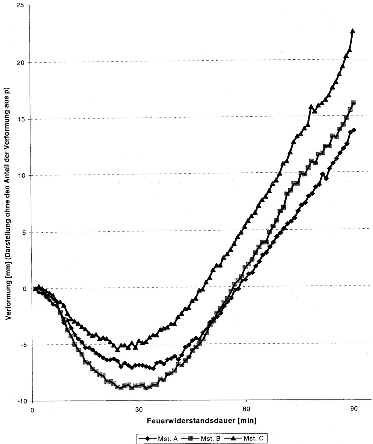
Verformungen am Probekörper
