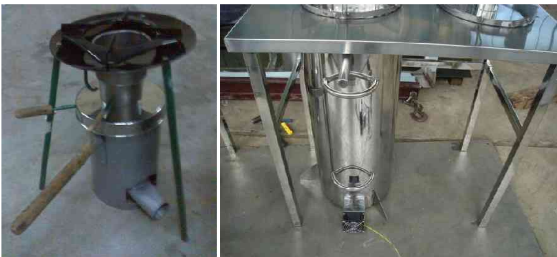
Obrázek 2: Dva příklady zplyňovacích vaříčů – vaří se na nich jako na plynovém sporáku. Výkon velkého nezrezového lze regulovat malým ventilátorem (převzato z http://www.bioenergylists.org )
