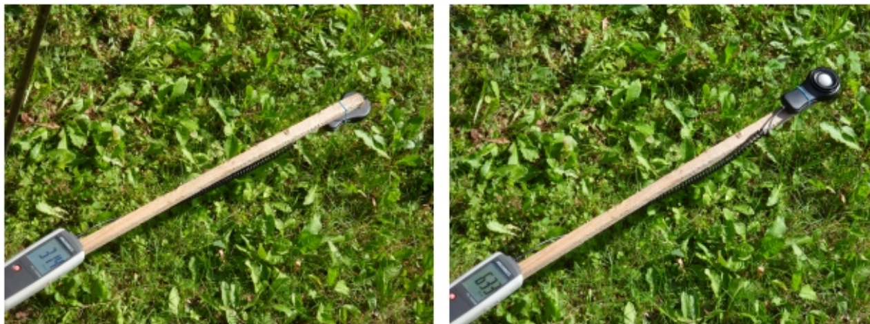
Obrázek 5.8: Měření solárního albeda trávy s užitím slunoměru za neproměnných podmínek (bezoblačná obloha). Senzor je udržován 3 dm nad zemí. Na levém snímku zaznamenává záření odražené travnatým povrchem, na pravém pak dopadající sluneční záření. Tým postup se užívá pro měření albeda vizuálního, luxmetrem. Užití metrové latě je lepší, než držet senzor rukou, protože pozorovatel stojí dál a potlačí se tedy vliv stínu pozorovatele... Ten má samozřejmě stát tak, aby jeho stín šel pryč od senzoru.
