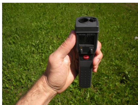
Obrázek 5.5: Měření LWIR teploty oblohy poblíž zenitu s užitím infrateploměru.
