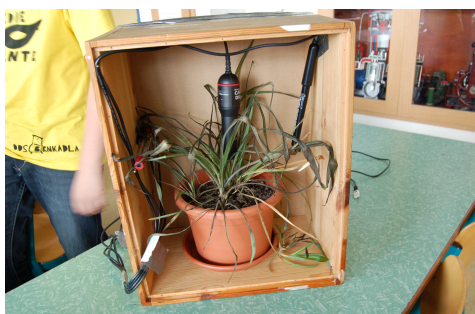
Obrázek 7.5: Sestava rostliny a senzorů v bedně po skončení měření. Na rostlině je patrné poškození extrémními podmínkami.
