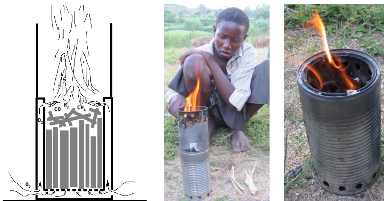
Obrázek 6.2: Schéma dřevoplynových kamen TLUD (vlevo), provedení kamen TLUD ze tří plechovek (uprostřed) a detail plamenů při mísení dřevoplynu s předehřátým vzduchem (vpravo).
