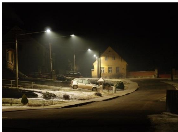
Obrázek 24: Takto ANO: Svítidla by měla být instalována vodorovně. S problémem nevhodně umístěných sloupů daleko od silnice se dá vypořádat použitím delších výložníků. Pak není nutné naklánět samotná svítidla. Na pravém obrázku si však lze všimnout osvětlené fasády rodinného domu – to by se u dobrého osvětlení stávat nemělo.
