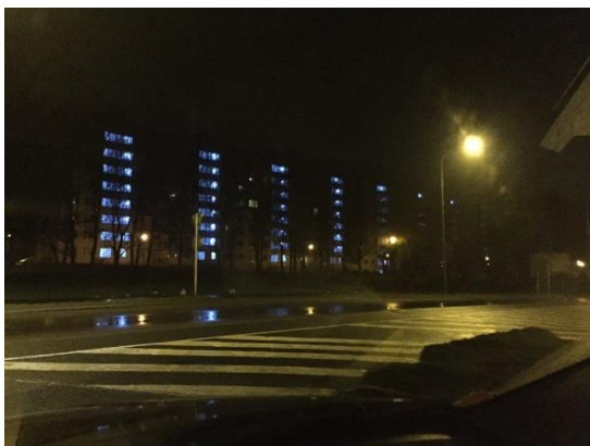
Obrázek 17: Schodiště bytových domů s LED osvětlením s CCT přes 5500 K. Foto archiv Luxvitaest.
