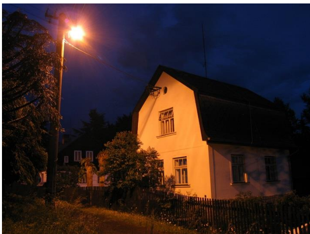
Obrázek 28: Takto NE : Takto by veřejné osvětlení v žádném případě vypadat nemělo. V obou případech jsou použita svítidla, která pro danou situaci nevyhovují svými vlastnostmi ani způsobem instalace.
