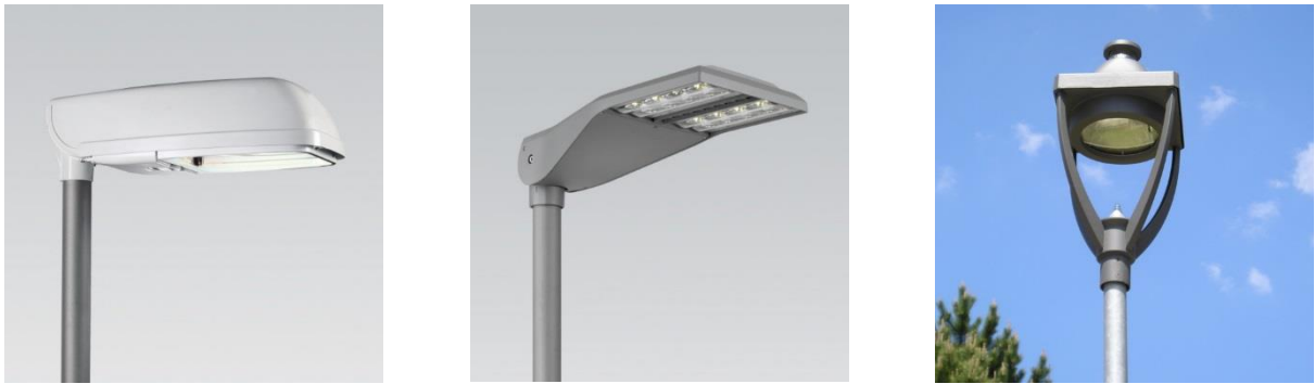
Obrázek 20: Takto ANO : příklady svítidel, která svítí pouze dolů, na oblohu neuniká žádné světlo. Rovněž při pohledu z dálky nejsou taková svítidla téměř vidět a neruší tedy ráz noční krajiny. Všimněte si plochého spodního krytu. Dá se říci, že pokud má svítidlo plochý spodní kryt, automaticky splňuje požadavky bodu 1). Svítidla používající LED by měla být vždy tohoto typu.
