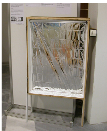
Obrázek 4.1: Model okna s elektricky navíjenou foliovou roletou
