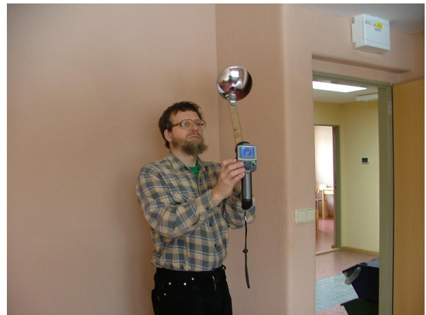
Obrázek 8.8: Snímání přes vypuklé zrcadlo vyžaduje, aby osoba pracující s kamerou byla na snímku zobrazena co nejméně. Na okraji zrcadla je nicméně nějaká její část vždy zachycena. Bylo by možné tomu čelit tím, že se dolní část zrcadla kolem úchytu a jeho dolní okraj polepí nebo natře, aby se tam odraz v LWIR oboru velmi snížil. To by též poskytlo informaci o teplotě zrcadla. (viz text str. 62)
