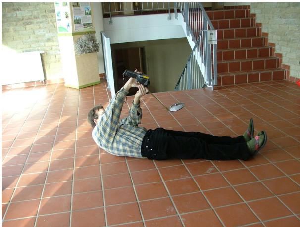
Obrázek 8.8: Snímání přes vypuklé zrcadlo vyžaduje, aby osoba pracující s kamerou byla na snímku zobrazena co nejméně. Na okraji zrcadla je nicméně nějaká její část vždy zachycena. Bylo by možné tomu čelit tím, že se dolní část zrcadla kolem úchytu a jeho dolní okraj polepí nebo natře, aby se tam odraz v LWIR oboru velmi snížil. To by též poskytlo informaci o teplotě zrcadla. (viz text str. 62)
