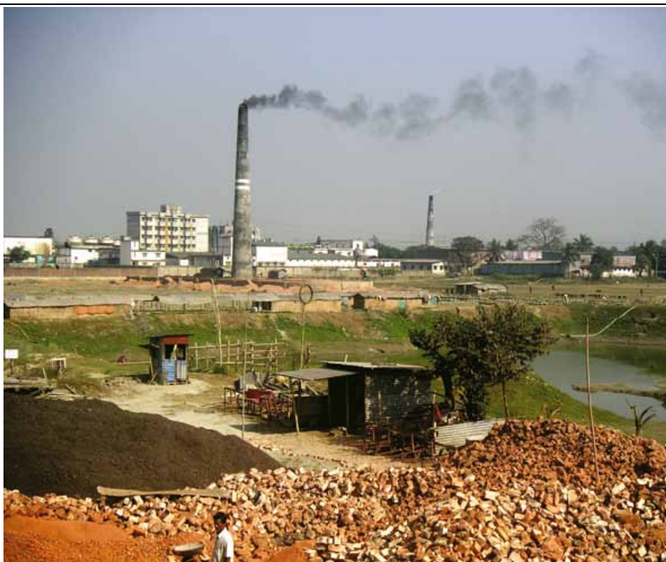
Tradiční pece na pálení cihel v jižní Asii jsou velkým zdrojem černého uhlíku. Zlepšení jejich konstrukce významně v tomto regionu významně snižuje emise. Zdroj: Kevin Hicks
