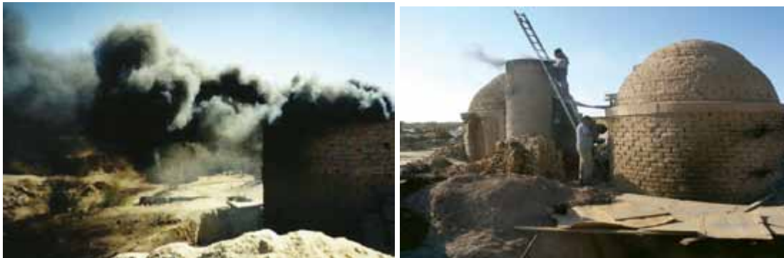
Tradiční pec na cihly (vlevo) a vylepšená konstrukce pece (vpravo) v provozu v Mexiku. Zdroj: Robert Marquez, zdroj: Alba Corral Avitia
