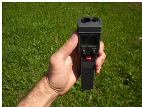
Obrázek 5.5: Měření LWIR teploty oblohy poblíž zenitu s užitím infrateploměru.
