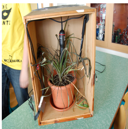
Obrázek 7.5: Sestava rostliny a senzorů v bedně po skončení měření. Na rostlině je patrné poškození extrémními podmínkami.
