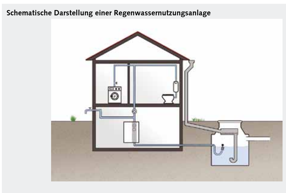
Abb. 8: Schematische Darstellung einer Regenwassernutzungsanlage. (BUB)
