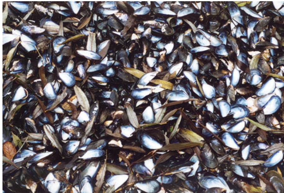
Figur 40. Blåmuslingeskaller bør ligge et par måneder på byggegrunden og afgasse inden brug.
