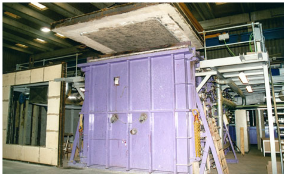
Figur 49. Lerpudset halmvæg efter test af brandbeskyttelsesevne af lerpuds på halm.
