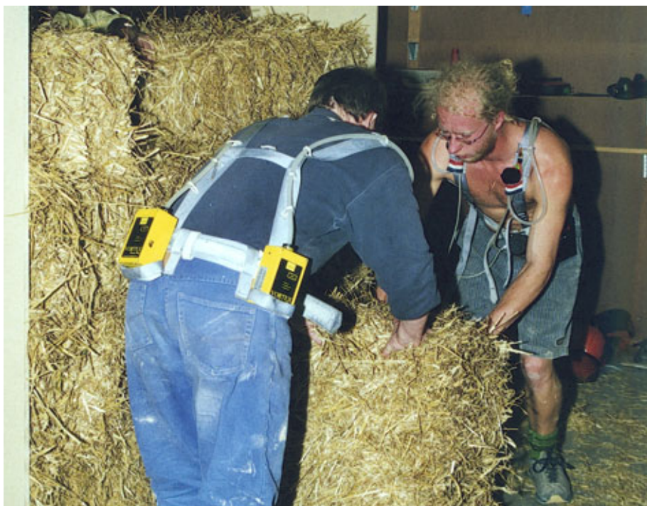
Figur 52. Måling af støv- og svampesporepotentiale ved opbygning af halmvægge på By og Byg.
