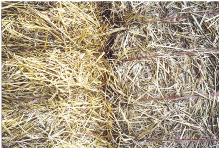
Figur 55. Anvendelse af friske, gule, skinnende halmballer til venstre i billedet kan anbefales til forskel fra de mindre friske halmballer til højre, der tydeligvis har begyndende skimmelsvampeangreb.
