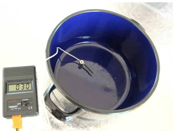
Obr. 3. Umístění termočláneku na dno hrnce pomocí dvou neodymových magnetů.
