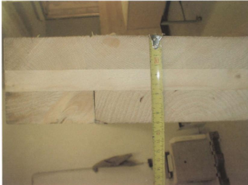
Grundkonstruktion: Kreuzlagen-Platte (dreischichtig)
