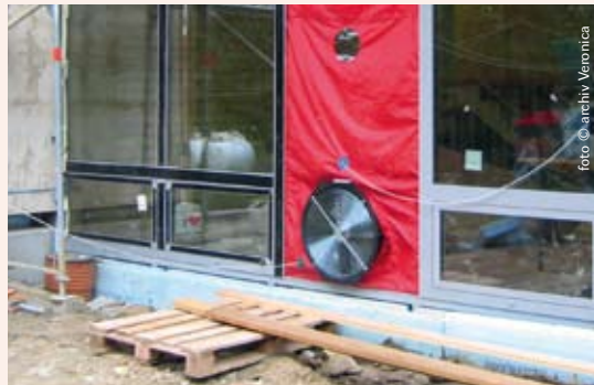
Ověřování vzduchotěsnosti budovy po osazení oken a dveří blower-door testem. | Blower-door testing of windows and doors.
